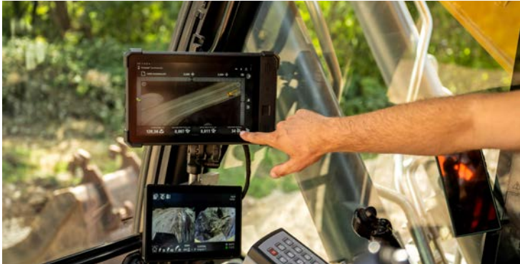
Machinisten zijn minder afhankelijk van handmatige controles en hebben de juiste maatvoering altijd paraat.
