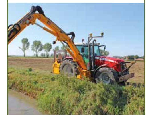
Op het draaipunt van de giek is een mast gemonteerd met twee GPS-ontvangers. Bij het zwenken naar voren, bijvoorbeeld voor transport, draaien de ontvangers over de cabine heen.
