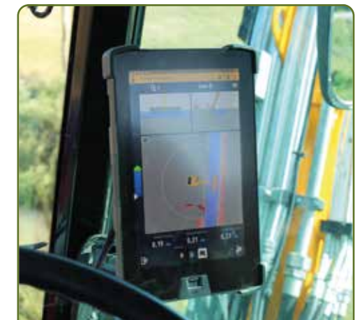
Op de tablet met Earthworks-licentie is exact te zien waar en op welke diepte de maaikorf zich bevindt.
