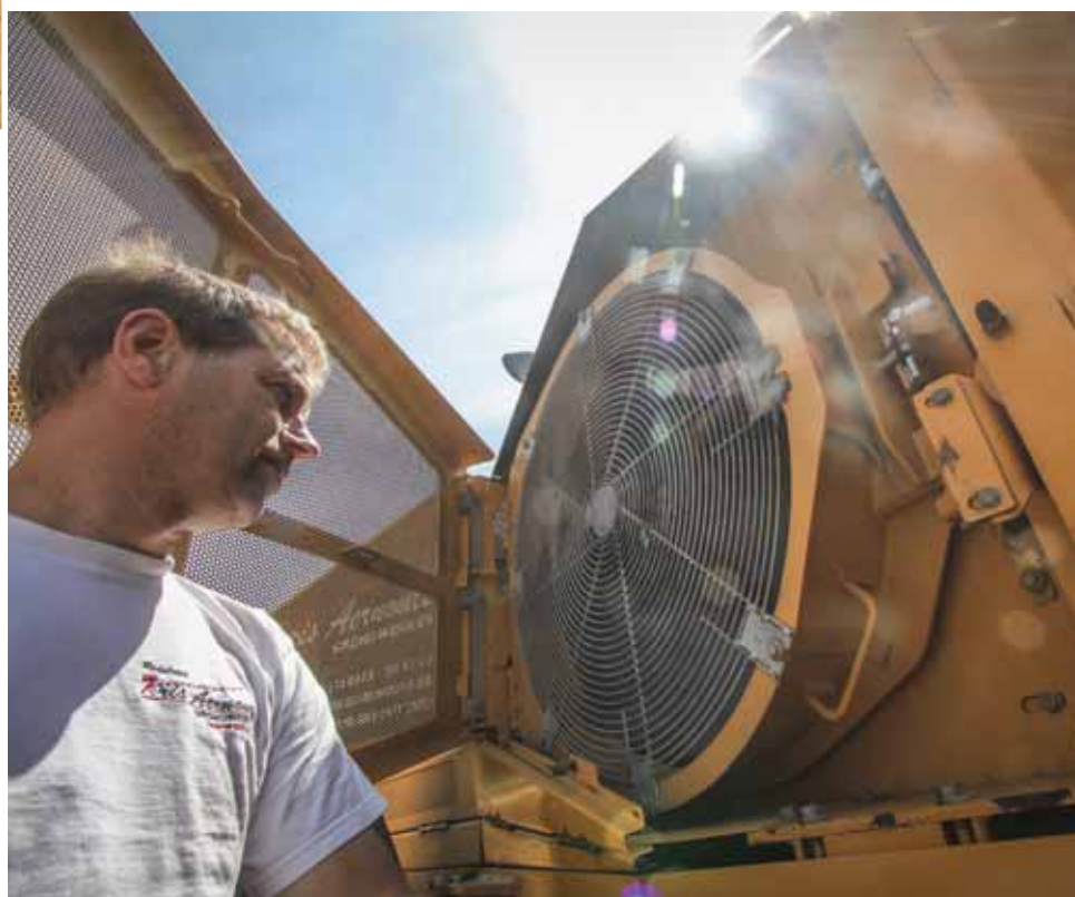
De machine is volledig hydrostatisch aangedreven. Tussen de motor en cabine is dan ook een enorme koeler opgebouwd om de hydrauliekolie terug te koelen.
