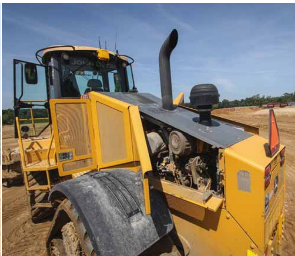
De zescilinder John Deere motor ligt helemaal achterop onder de kap.
