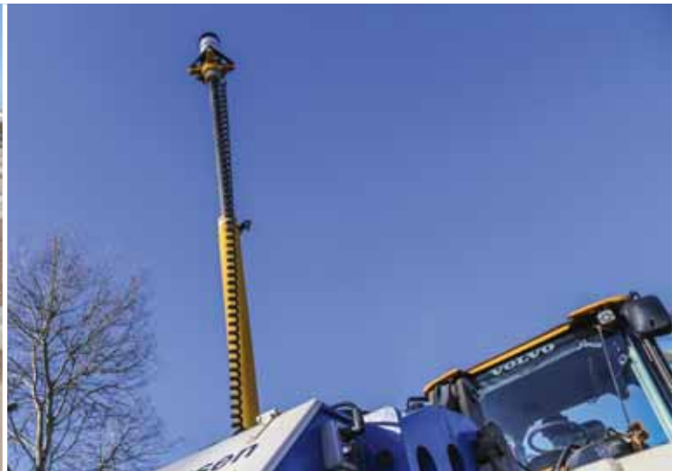
Op de Mekos-leveller zit een Trimble-telescoopmast met prisma-ontvanger. Joris schuift deze uit zodat deze boven de cabine uitkomt. Zo rijdt hij met de wiellader nooit in zijn eigen signaal.
