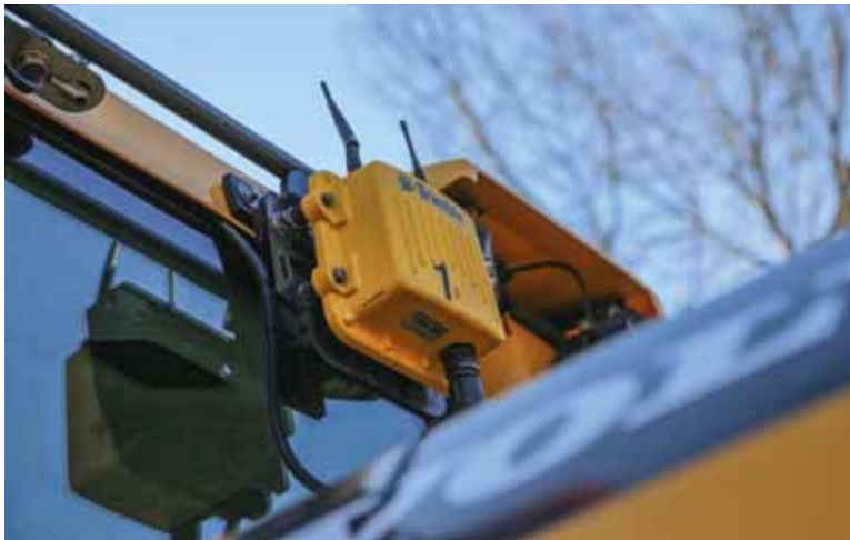
Achterop de Volvo zit een radio-ontvanger. Het total station staat hiermee in verbinding en stuurt de gegevens voor de boordcomputer draadloos door. De boordcomputer grijpt in op de hydrauliek en stuurt volautomatisch de hoogte en verkanting op de leveller aan.
