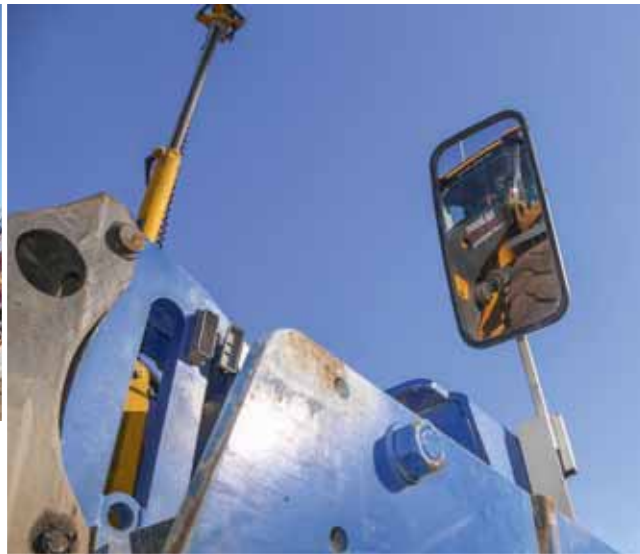
Rob Janssen monteerde op beide kanten van de leveler een spiegel. Dat maakt nauwkeurig werken langs trottoirbanden mogelijk.
