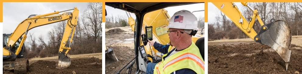
TRIMBLE EARTHWORKS STYRER BOM OG SKOVL
